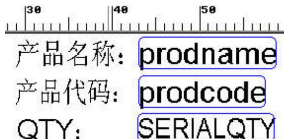
上方左侧为 XXX 公司的数据库内容, 当用 Scanner 扫描数据库中第一列 ID 的内容, 自动打印出内容包含 prodname、prodcode、SERIALQTY 的标签, 打印的数量根据系统变量 SERIALQTY 的数值而定。就是说, 当扫描到的条码值为 “3” 时, 将会打印出 9 张含有 “梨”、“10003”、“9” 内容的标签. 右侧为标签模板.
