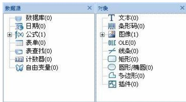
使用键盘上的向上箭头和向下箭头键可以在树结构中向上和向下移动。使用 + 和 - 符号可展开或收缩列表，以及显示与每个数据源关联的变量列表或每个类别中可用的对象。
