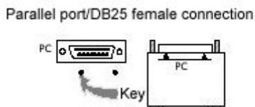
如果您需要在同一并行端口中连接打印机，只需将打印机插头插入到软件保护密钥中。可能需要启动打印机，以便识别软件保护密钥。
